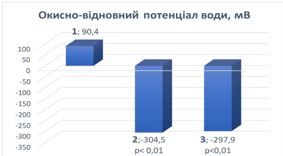
Рис. 3.1 - Величина окисно-відновного потенціалу (мВ) води: 1 – звичайна водогінна вода, 2 – вода від’ємного окисно-відновного потенціалу з обробкою препаратом мікрогідрин, 3 – вода від’ємного окисно-відновного потенціалу з додатковим насиченням молекулярним воднем. p – вірогідність різниць порівняно до звичайної водогінної води (непараметричний тест Манна-Уїтні).
