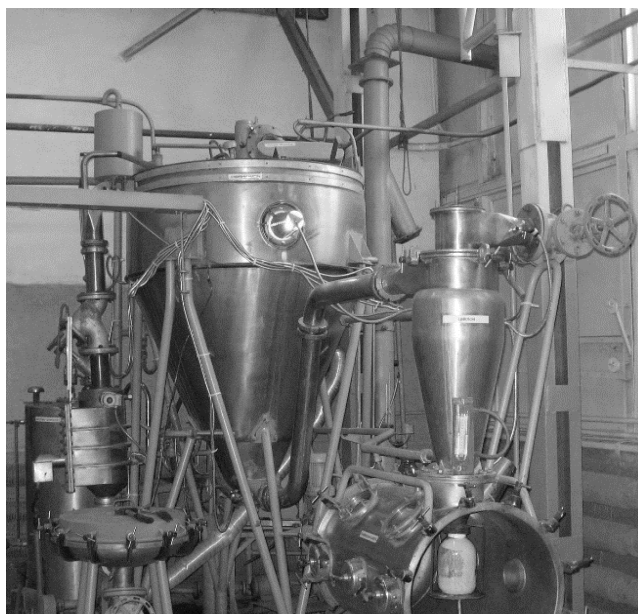
Рисунок 1 - Експериментальна розпилювальна сушарки РЦ-1,3 продуктивністю 10кг/год за випареною вологою
