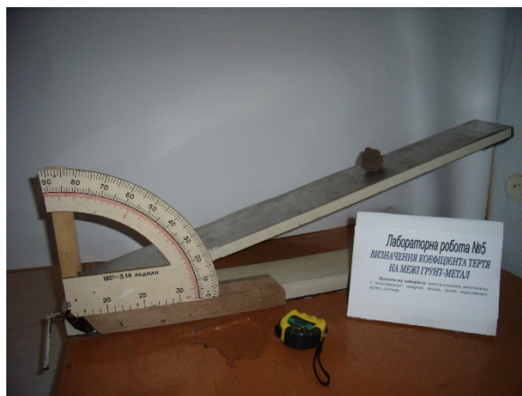
Рис. 4 - Лабораторна установка для визначення коефіцієнта тертя на межі метал-ґрунт
