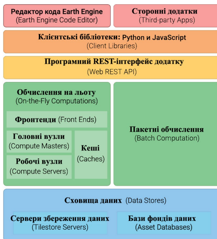
Рисунок 2. Спрощена схема архітектури Google Earth Engine
