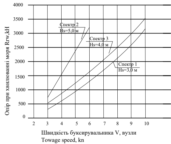
Рисунок 2.2 – Залежність буксирувального опору маломорехідного об’єкту від швидкості буксирування з урахуванням хитавиці Джерело: розроблено автором
