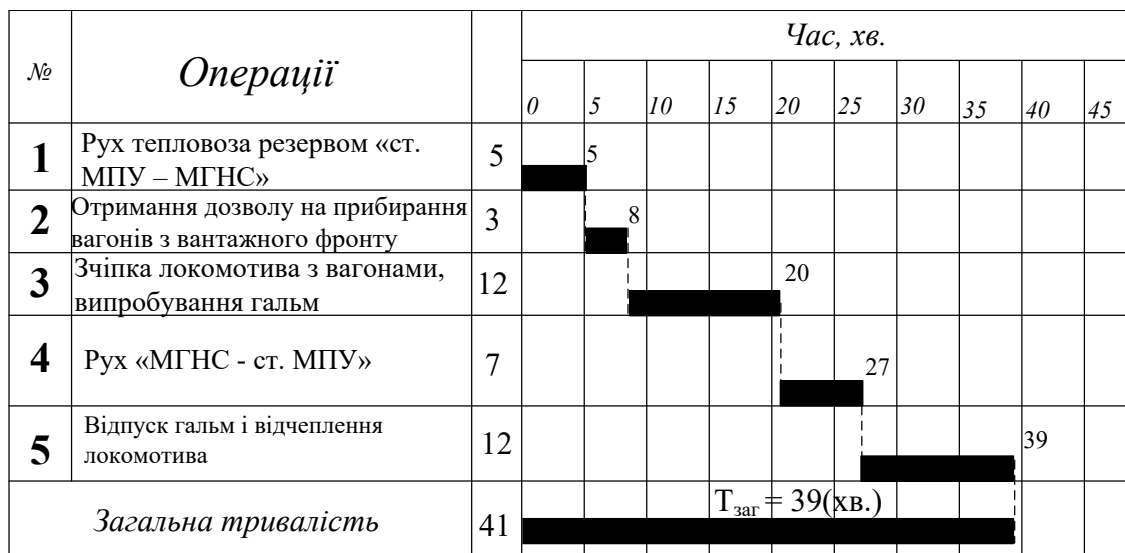
Рисунок 4 – Технологічний графік роботи локомотива при прибиранні вагонів з підприємства ВАТ «МГНС»
