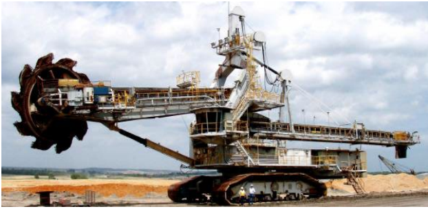
Рисунок 1.3 – Роторний екскаватор Demag HD800. В даний час екскаватор використовується компанією NRG Energy на вугільній шахті в Техасі.
