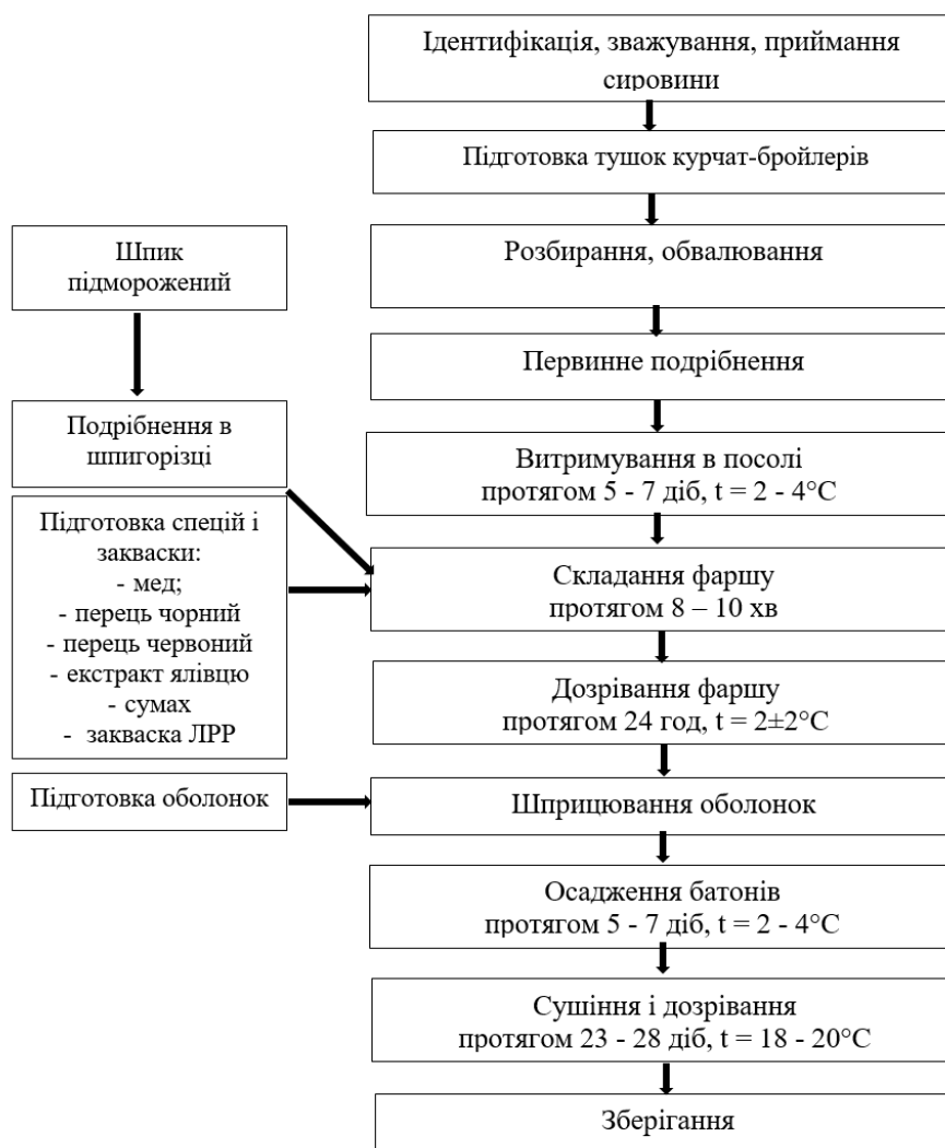
Рисунок 1 – Технологічна схема виробництва сиров'яленої ковбаси
