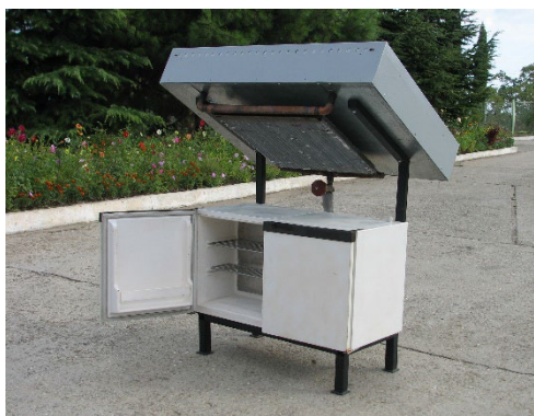
Рисунок 4 – Принципова схема і загальний вигляд сонячного адсорбційного холодильника: 1 – генератор-адсорбер; 2 – сонячний колектор; 3 – повітряний конденсатор; 4 – випарник; 5 – холодильна камера.
