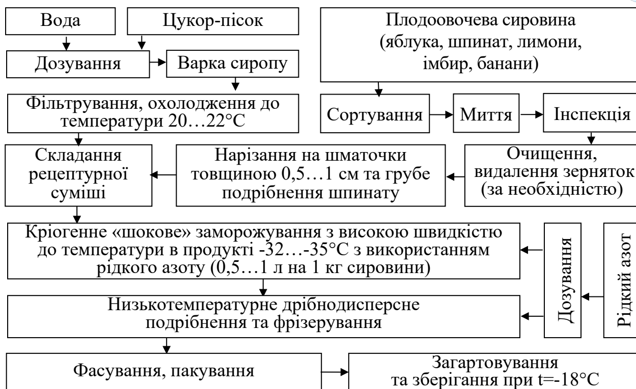
Рисунок 15 - Принципова технологічна схема виробництва «зеленої лінійки» плодовоовочевого морозива-наносорбетів з використанням кріогенного «шокового» заморожування та низькотемпературного дрібнодисперсного подрібнення
