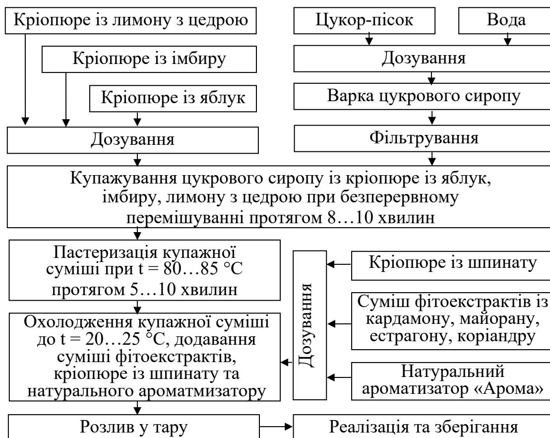
Рисунок 14 – Принципова технологічна схема виробництва «зеленої лінійки» нанонапоїв для оздоровчого харчування із застосуванням заморожених дрібнодисперсних кріопюре із хлорофілвісних овочів
