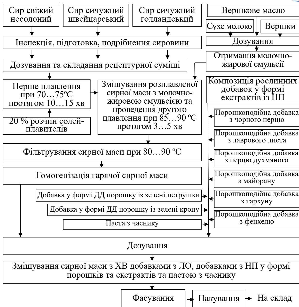
Рисунок 28 - Принципова технологічна схема виробництва плавлених сирів «Богатир» та «Апетитний» з використанням хлорофілсвімісних добавок у формі ДД порошків із зелені петрушки та кропу та рослинних добавок із НП у формі екстрактів та порошків
