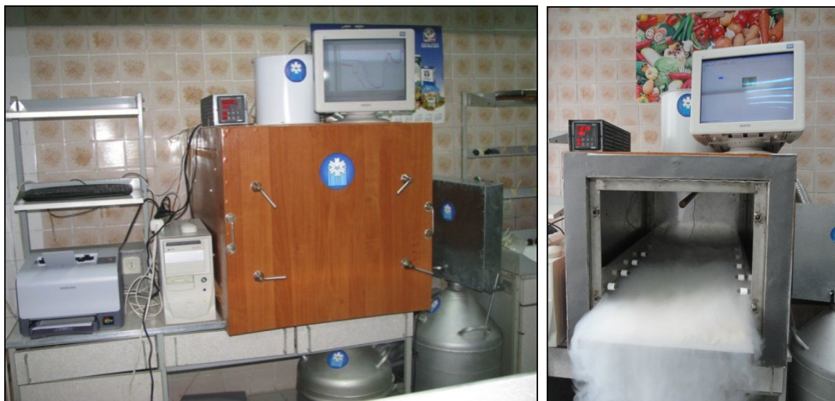
Рисунок 4 - Кріогенний програмний заморожувач періодичної дії з комп'ютерним забезпеченням
