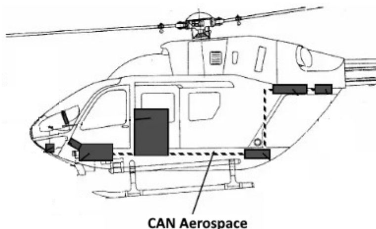
Рисунок 3 – Спеціалізована цифрова мережа CAN Aerospace у всепогодньому рятувальному гелікоптері Eurocopter (AWRH)
