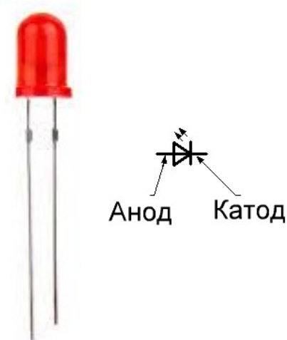
Рисунок 1.8 - Світлодіод та його принципова схема.
